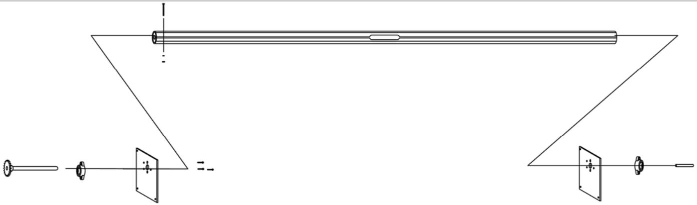
1. Medir la distancia entre el interior al interior de los conjuntos de placa de rodillos.
