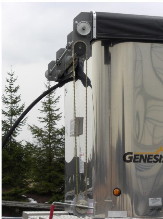
4. Cuelgue la cadena o correa trapezoidal de la rueda dentada superior o polea en el eje y fíjela a la polea del mango o rueda de espigas. Ajuste en la caja de volcado donde se va a montar el conjunto de asa, asegurándose de que el cinturón o - la cadena es recta y no se atará al arrancar. Para la correa en V, estire para que el cinturón tenga holgura mínima. Para la cadena, cortar cualquier cadena en exceso y conectar los extremos utilizando el enlace maestro proporcionado.
